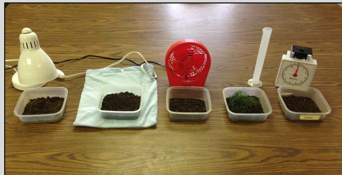
Figura 2. Cinco recipientes experimentales con materiales de tratamiento (de izquierda a derecha): lámpara de calor, compresa de calor, ventilador de escritorio, musgo español y control
